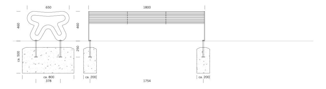
BODENVERANKERUNG ZUM ANSCHRAUBEN, EINBAUTIEFE 80 MM
